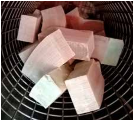
Fig. 5: Campione di pala eolica in vetroresina
