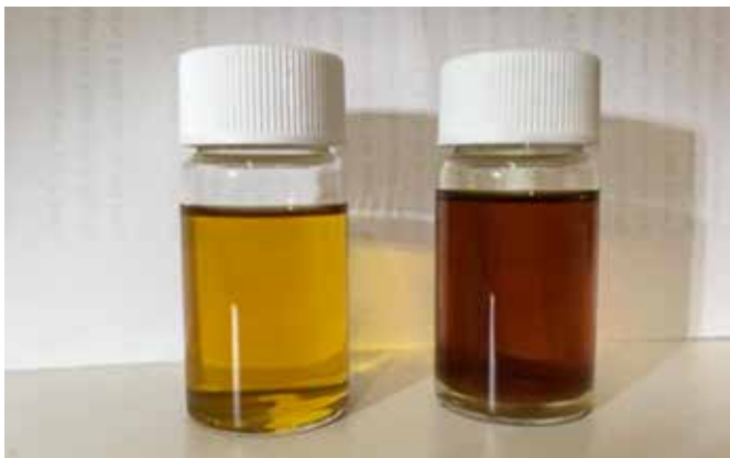
Fig. 1: Liquido prodotto dal processo Korec riutilizzabile per la produzione di vetroresina Fig. 2: Fibra di vetro prodotta dal processo Korec
